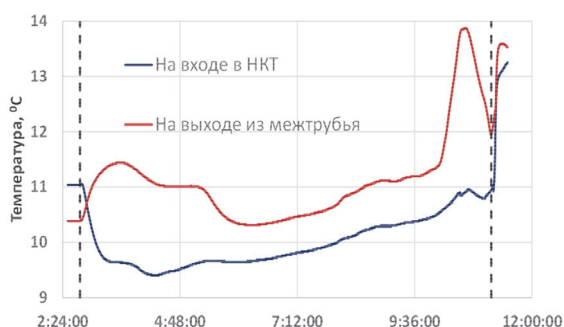
Рисунок 5. Динамика изменения температуры промывочной жидкости. Пунктиром обозначен временной интервал, в котором проводилась промывка
