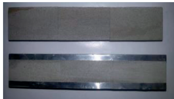
Рисунок 3. Пример крновой модели «идеальной» трещины
