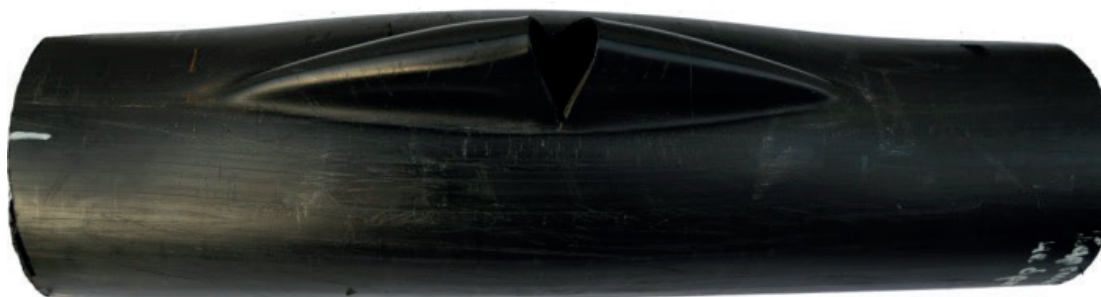
Рисунок 2. Образец трубы 110 мм ПВП тип «Т» по ТУ 6-19-051-538-85 после испытаний на стойкость к постоянному внутреннему давлению. Деформирование трубного образца с характерной зоной пластического выпучивания материала в зоне разрушения свидетельствует об отсутствии признаков значимых деструкционных изменений и ухудшения эксплуатационных качеств
