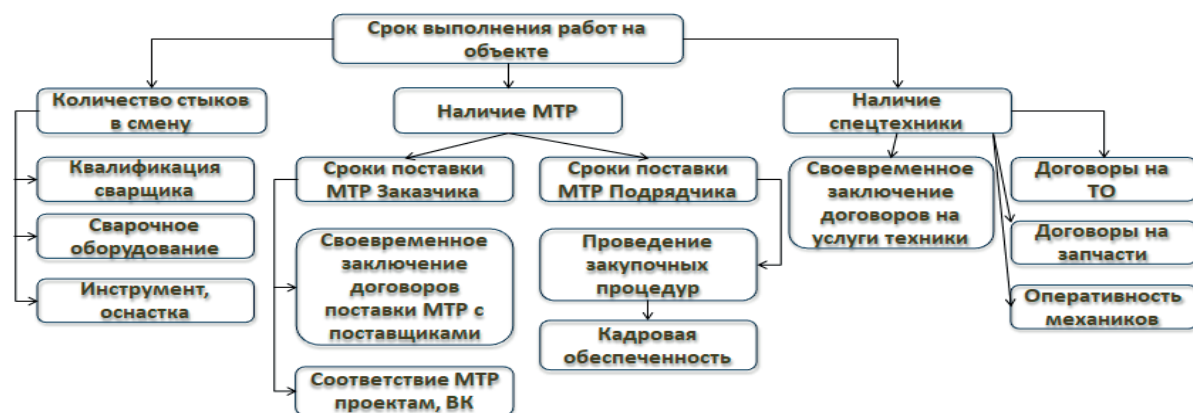
Рисунок 1. Схема взаимосвязей и факторов, влияющих на сроки выполнения сварочных работ при строительстве трубопроводов
