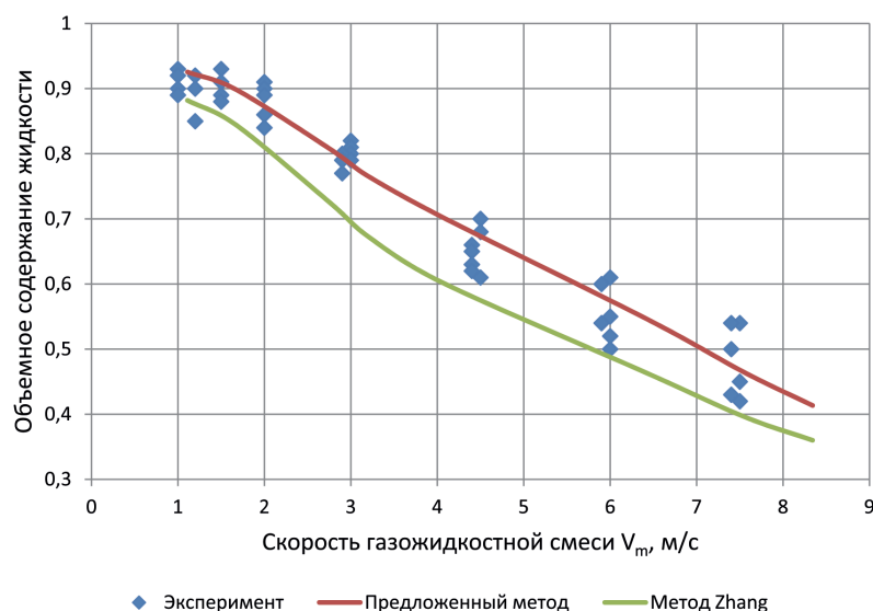
Рисунок 5. Сопоставление расчётных данных объёмного содержания жидкости в жидкостной пробке с экспериментальными данными [8] в горизонтальном трубопроводе
