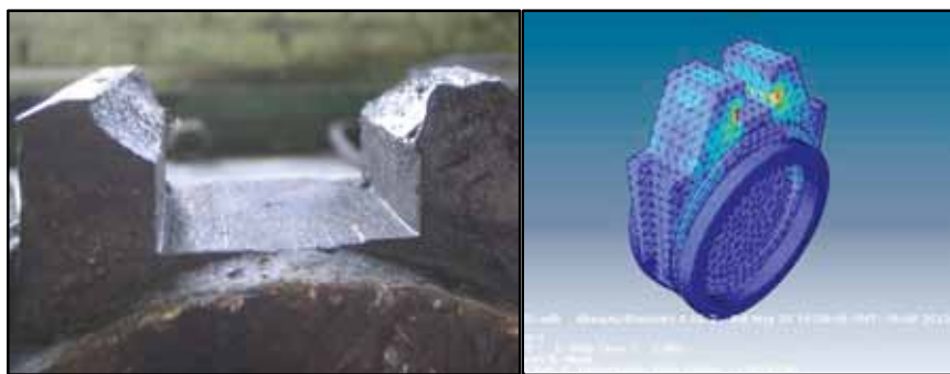
Рисунок 3. а - соответствие зон разрушения в области зацепов клина; б - картина распределения максимальных эквивалентных напряжений
