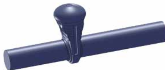
Рисунок 5. 3D-модель проточной части клиновой задвижки ЗКЛ2 250-25
