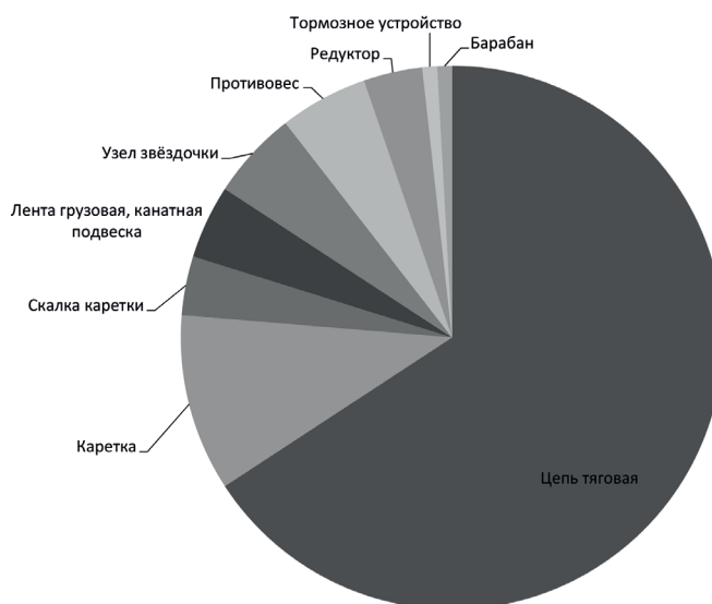
Рисунок 1. Распределение отказов цепного привода по узлам за 5 месяцев 2016 г.
