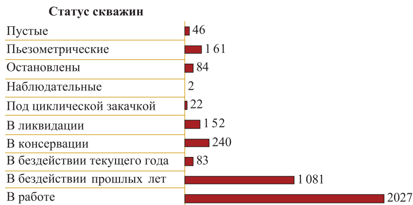
Рисунок 1. Распределение фонда скважин, оборудованных установками ЭЦН, по статусу.
