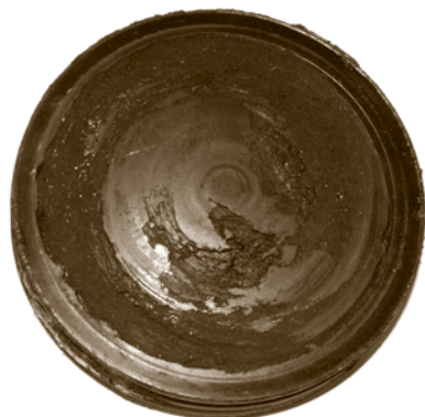
Рисунок 6. Излом вала по месту разрушения
