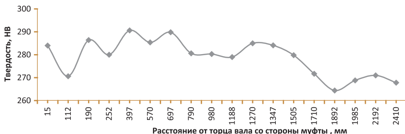
Рисунок 11. Распределение твердости по поверхностному слою вала НМ 10000-210
