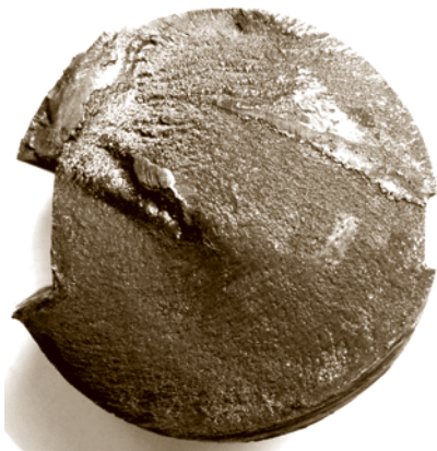
Рисунок 3. Излом вала по месту разрушения.
