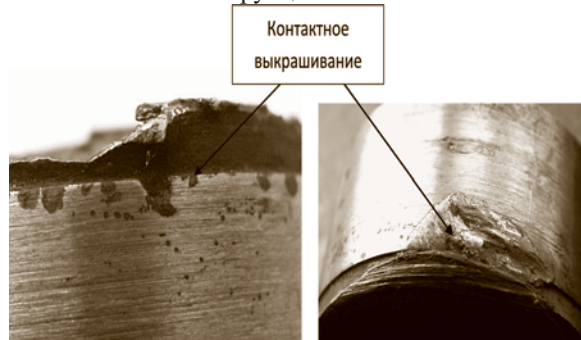
Рисунок 2. Контактное выкрашивание в месте посадки муфты.
