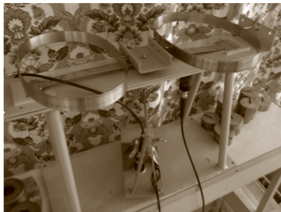
Рисунок 10. Установка датчиков на виброизолятор
