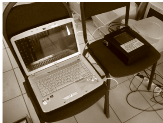
Рисунок 11. Синхронизация виброанализатора с компьютером
