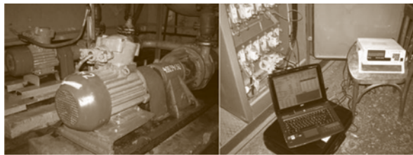
а) структурная схема; б) внешний вид Рисунок 1. Экспериментальная установка для исследования центробежных насосов с электроприводом
