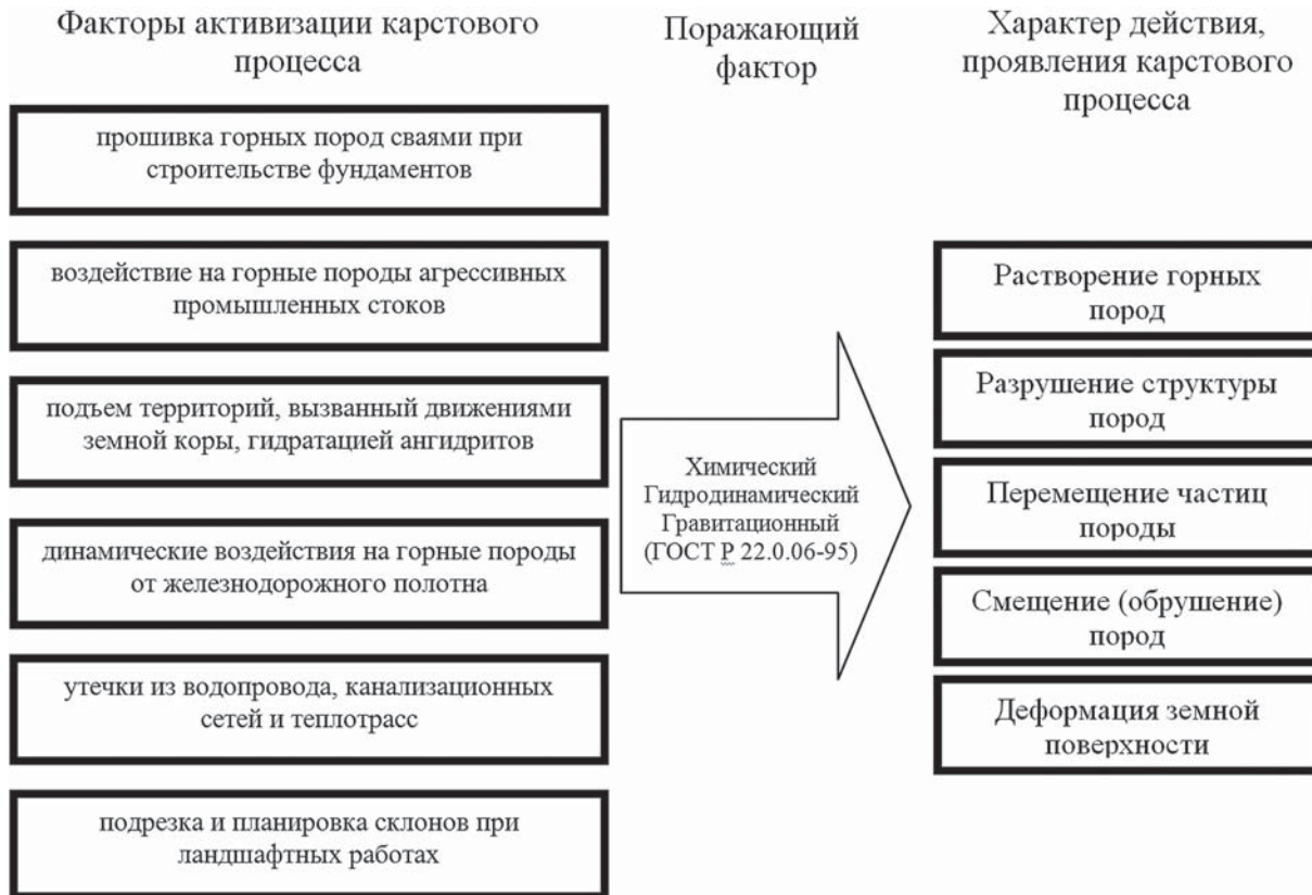
Рисунок 1. Схема негативного проявления карстовых процессов
