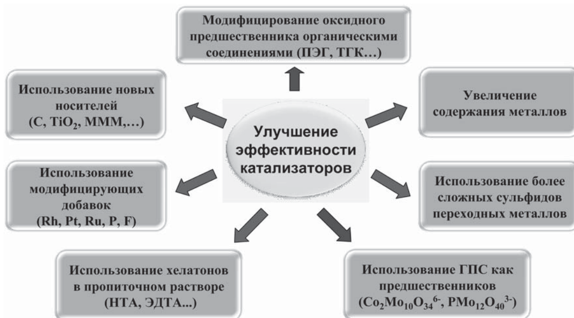
Рисунок 5. Способы улучшения эффективности катализаторов гидроочистки
