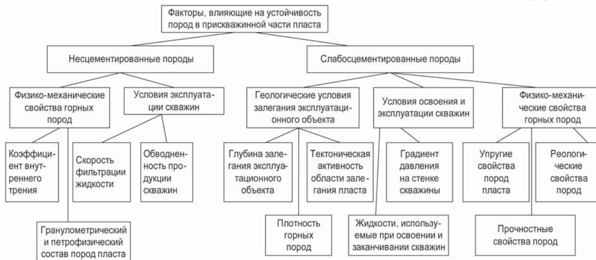
Рисунок 1. Факторы, влияющие на устойчивость прискважинной части пласта к разрушению
