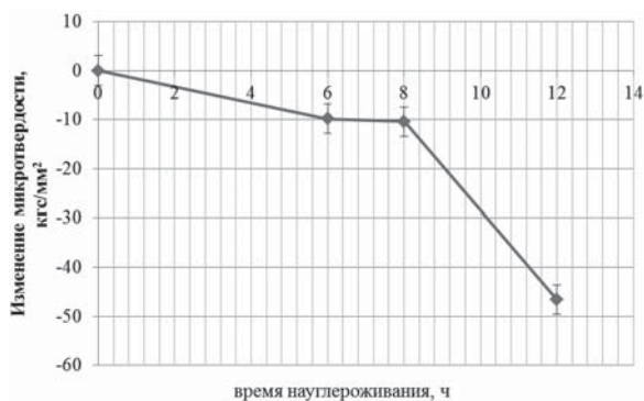
Рисунок 1. Изменение микротвердости образцов стали 20 после ХТО в сравнении со значением микротвердости образцов до ХТО
