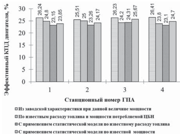
Рисунок 5. Результаты расчетов эффективного КПД газотурбинных двигателей ГПА-Ц-16.
