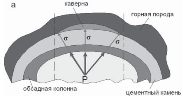
Рисунок 4. Механизм возникновения среза в цементном камне: а) общий вид; б) выделенный фрагмент цементного камня; Р — давление, создающее динамическую нагрузку, \sigma — нормальные напряжения, создающие одновременное растяжение и сжатие по двум взаимно перпендикулярным направлениям, \tau — касательные напряжения сдвига, ОА и ОВ — зоны возможного возникновения среза
