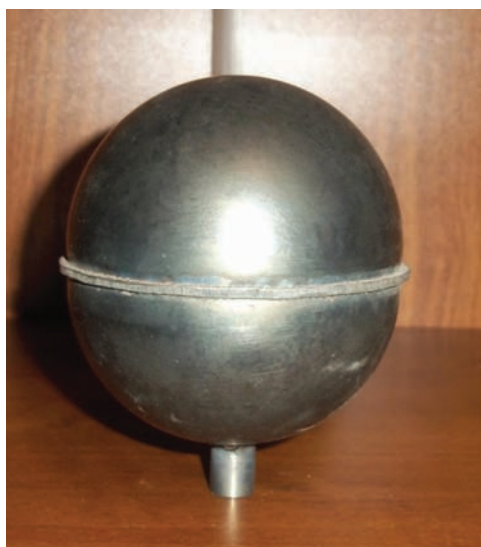
Рисунок 9. Сферический поплавок диаметром 90 мм из промышленного титанового сплава ВТ6 (Ti-6Al-4V), отформованный из круглого пакета в состоянии сверхпластичности. В этом случае a_f=b_f=H_f=45 мм, \alpha_f=\beta_f=\pi/2 , a_f/b_f=a_0/b_0=1 , a_0=b_0=56,4 мм
