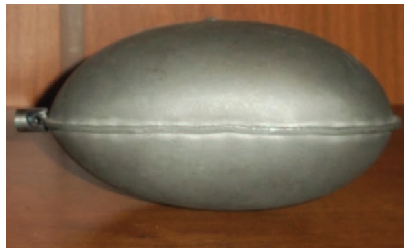
Рисунок 10. Эллипсоидальный поплавок из промышленного титанового сплава ВТ6 (Ti-6Al-4V), отформованный из эллиптического пакета в состоянии сверхпластичности. Геометрические размеры 90 \times 90 \times 160 мм. В этом случае a_f=H_f=45 мм, b_f=80 мм, \alpha_f=\pi/2 , \beta_f=1,0248 , a_f/b_f=0,5625 , a_0/b_0=0,737 , a_0=61,6 мм, b_0=83,7 мм
