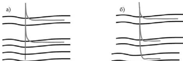
Рисунок 19. Схематичное отображение заканчивания скважин: а) вариант с бурением горизонтального ствола на пласты Ю 1 1 , Ю 1 3 и вертикального окончания на пласт Ю 2 , б) отображение варианта с реализацией трех горизонтальных стволов
