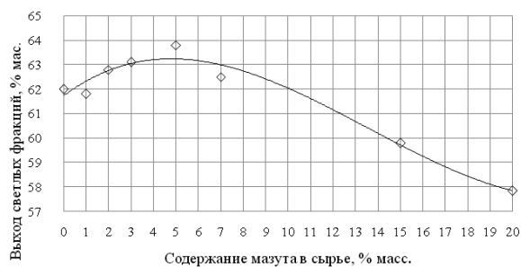
Рисунок 6. Зависимость выхода светлых фракций от содержания мазута в газовом конденсате
