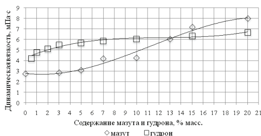
Рисунок 2. Зависимости динамической вязкости газового конденсата от содержания мазута и гудрона
