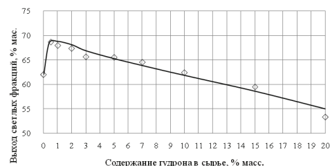
Рисунок 7. Зависимость выхода светлых фракций от содержания гудрона в газовом конденсате
