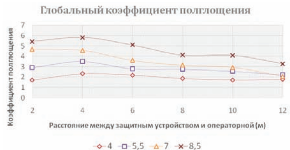
Рисунок 7. Зависимость глобального коэффициента поглощения от конструктивных параметров и расположения защитного устройства
