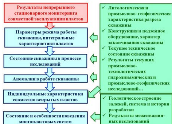
Рисунок 8. Задачи и информационная поддержка стационарного глубинного долговременного мониторинга в многопластовых нефтяных скважинах
