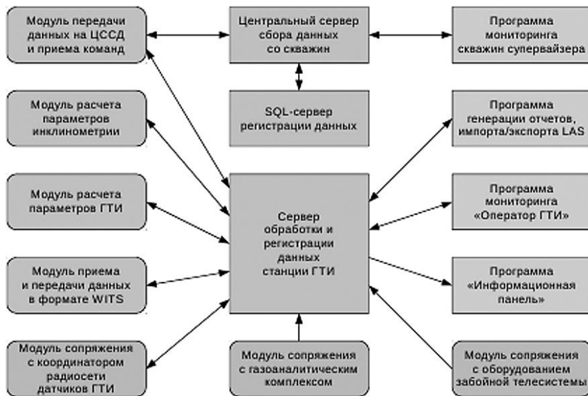
Рис. 2. Модульно-сетевая архитектура программного обеспечения АИС
