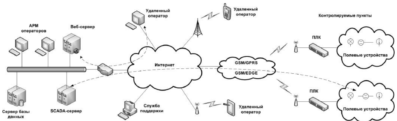
Рис. 4. Структура SCADA-системы на базе сети Интернет
